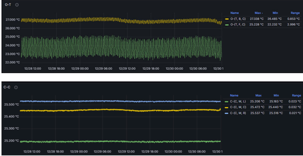
图 4.20 温控后 48 h 温度监测结果：(a) 外部环境温度波动；(b) 温控箱内温度波动。内外环境对比表明温控箱显著压低了长时间漂移。
