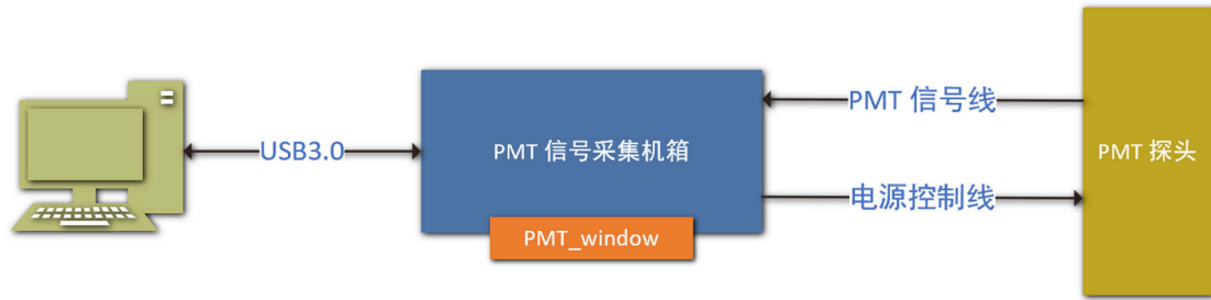
图 4.4 MCPMT 信号逻辑原理图。ARTIQ 通过 TTL 门控定义探测窗口，采集机箱完成 32 路计数缓存与回传，用于并行态判读。
